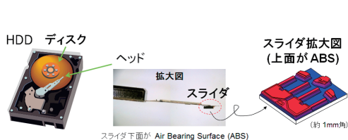
図2：HDDのスライダとABS
